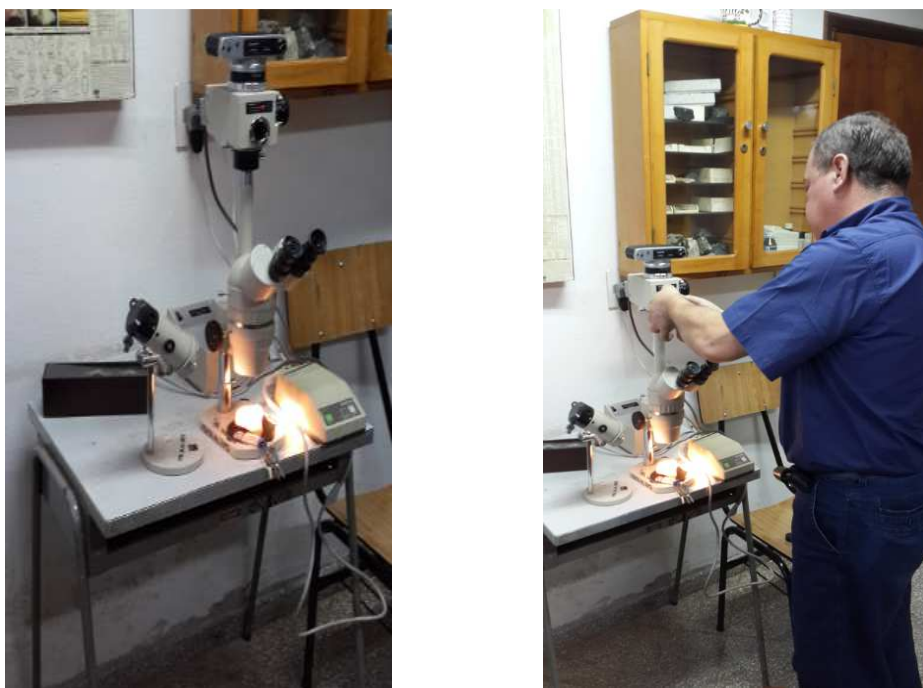
Figura 4. (a) y (b) Proceso de montaje para la observación y microfotografía de muestras de mano de afloramiento de areniscas.
