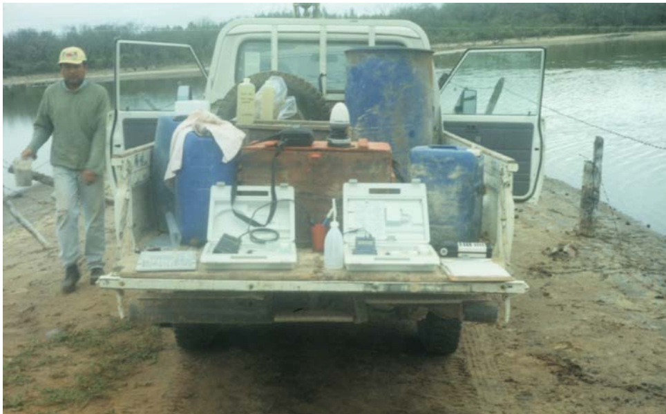
Foto 4 . Equipos utilizados para las mediciones del agua “in situ”
