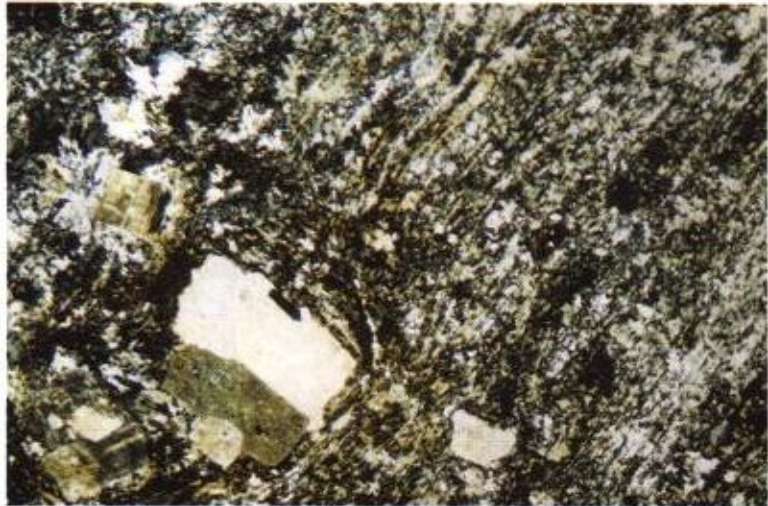
Foto 26: x ancho 0,32 mm, muestra HVF 3.2871 (Puente A° Paso Pindó, Ruta 1). Lava riolítica con estructura fluidal. En partes la matriz es microcristalina y a otra parte vitrea. Fenocristales grandes de feldespato K con macla de Carlsbad. A la izquierda fenocristales de plagioclasa con macla polisintética del tipo albita.
