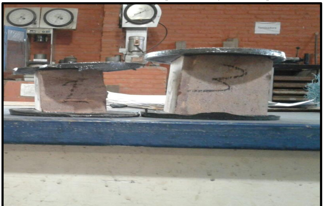
B10. Muestras introducidas a un cilindro para ser ensayados a compresión.
