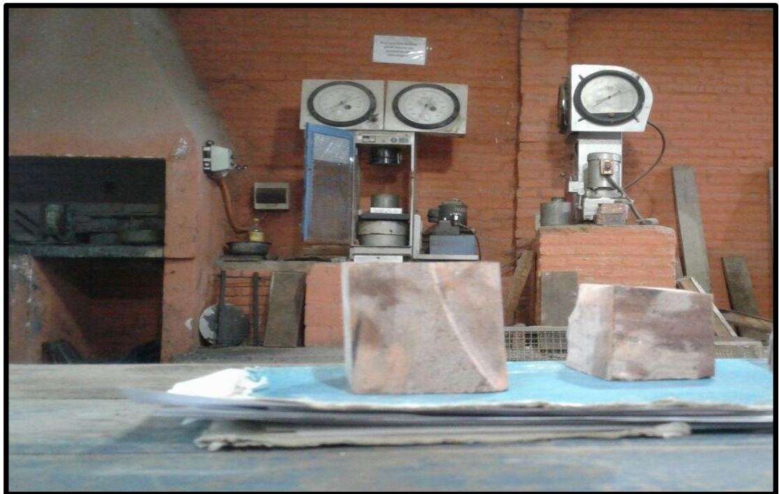
B10. Muestras introducidas a un cilindro para ser ensayados a compresión.
