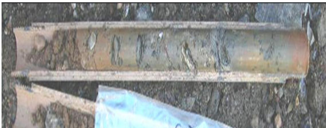
**Figura 8. Muestra obtenida de un ensayo SPT. (Auge, 2005).**
