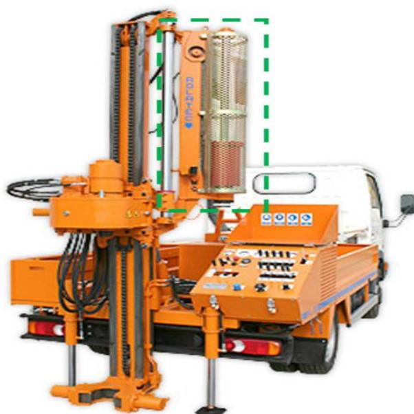
**Figura 9. Dispositivo de golpeo mediante maza automática. (Auge, 2005)**
