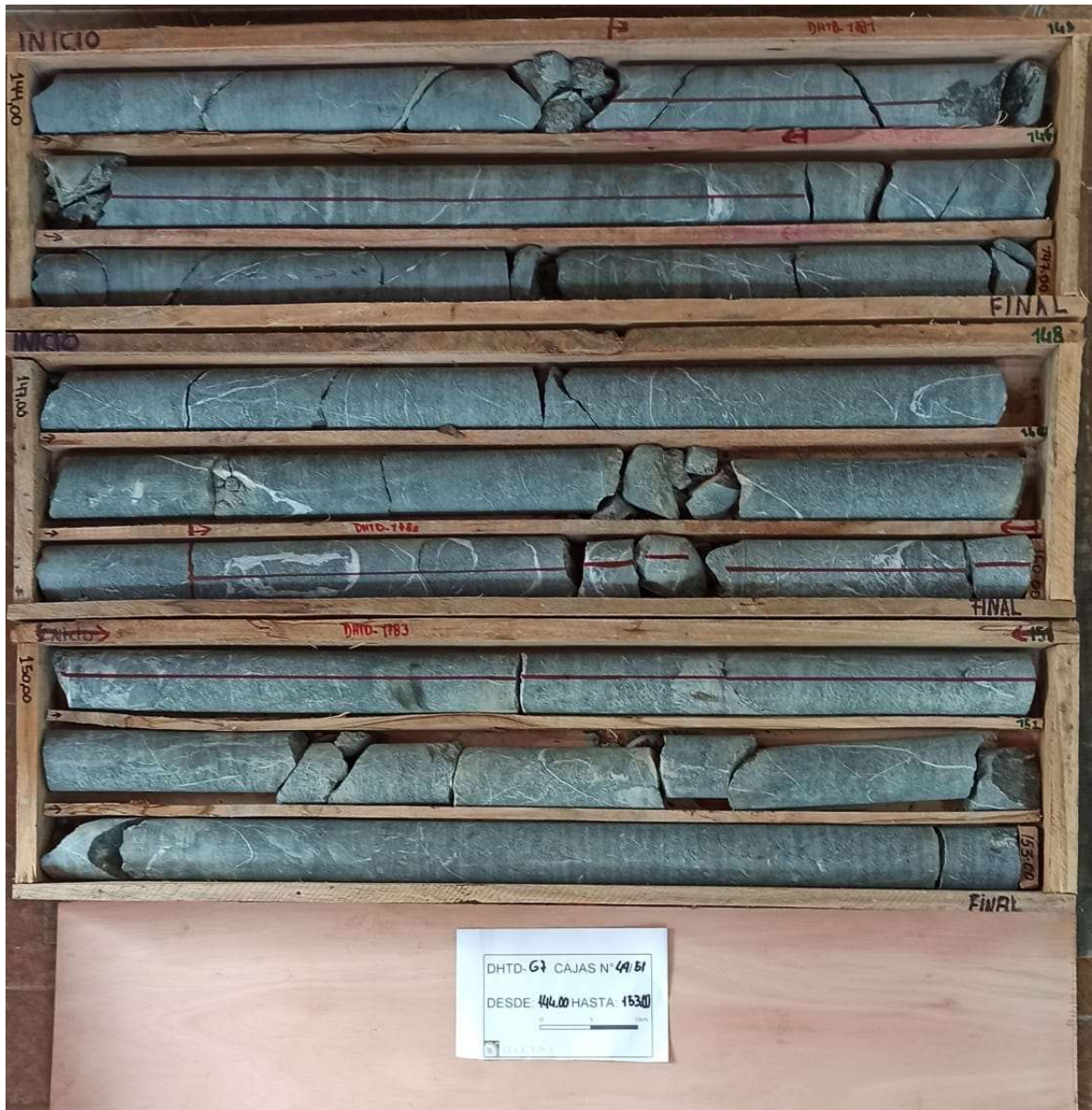
Muestras de los testigos, profundidad de 144.00 a 153.00 m. Se observa calcosilicatada con fracturas rellenas de calcita.
