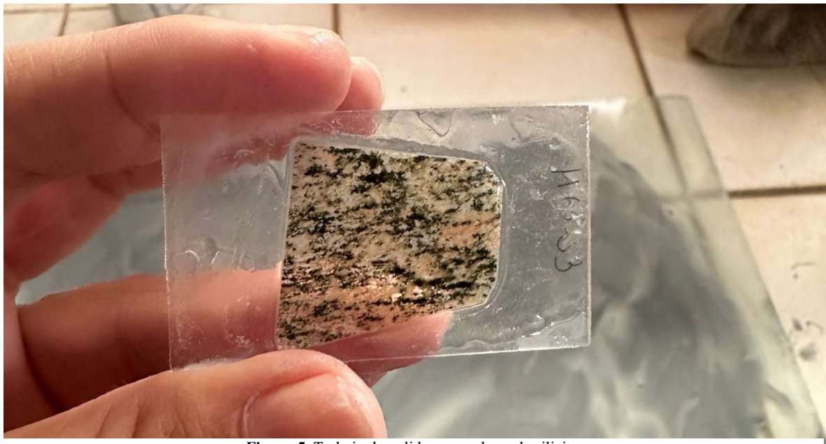
Figura 5. Trabajo de pulido con carburo de silicio.
