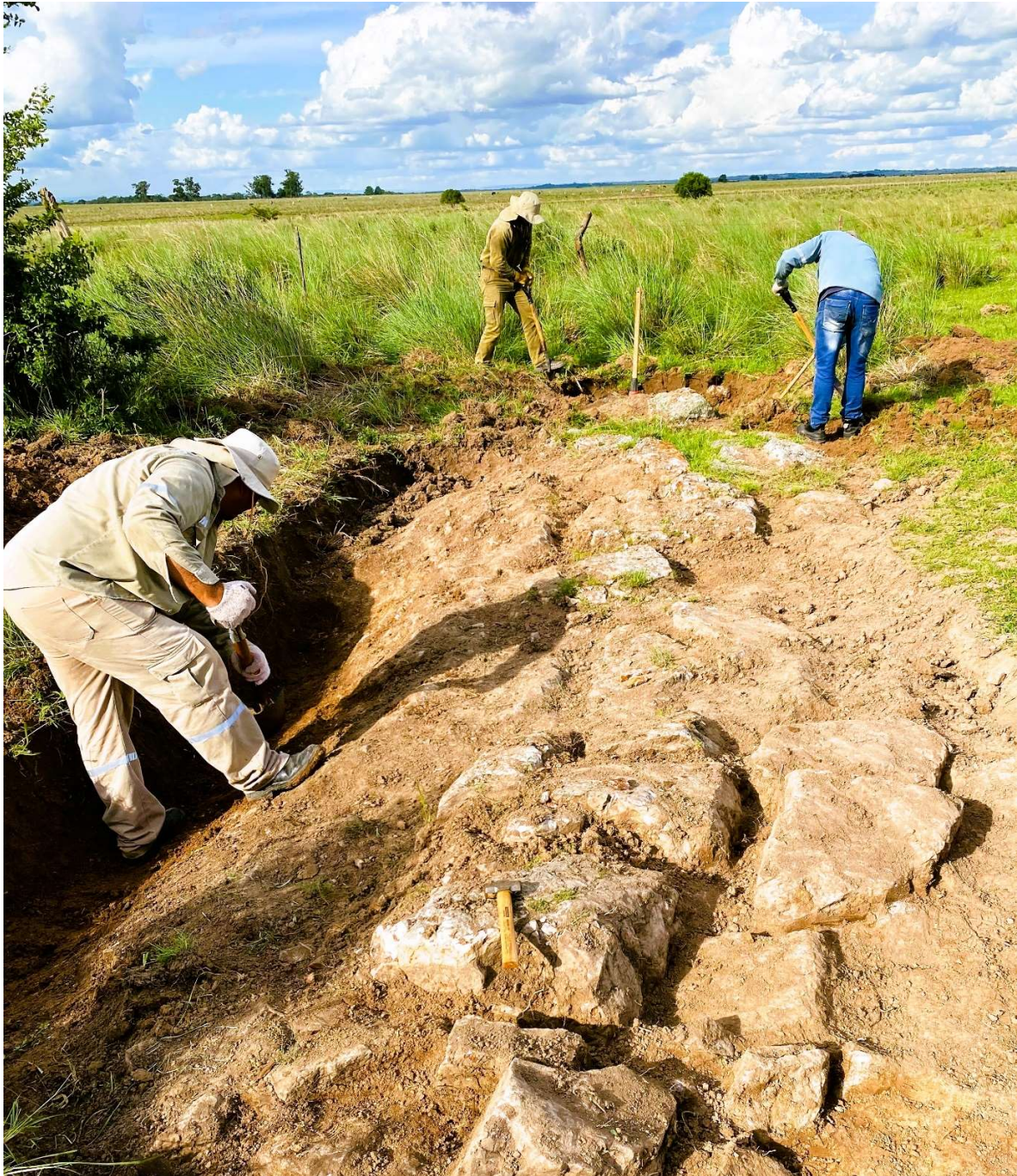
Inicio de trabajo de excavación para exponer cuerpos cuarcíferos. Foto gentileza.
