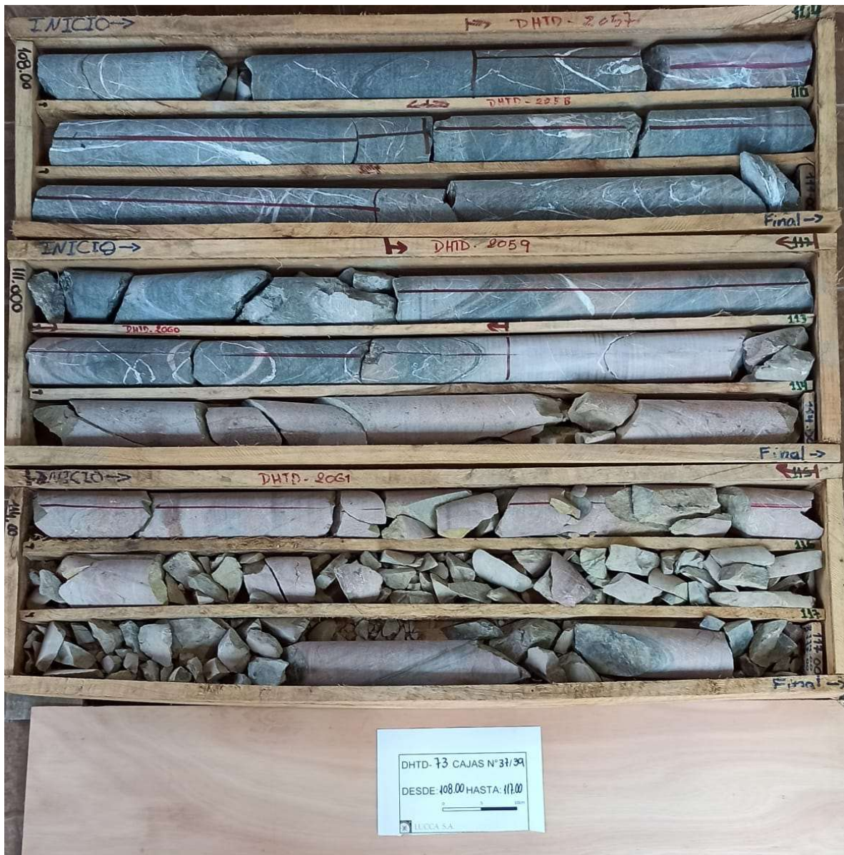
Muestras de los testigos, profundidad de 108.00 a 117.00 m. Calcita relleno de fracturas
