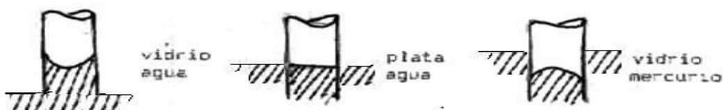
Figura 2.3 - Meniscos. 1. Adhesión > Cohesión, 2. Adhesión = Cohesión, 3. Cohesión > Adhesión. Tomado de Juárez y Rico. Mecánica de Suelos.
