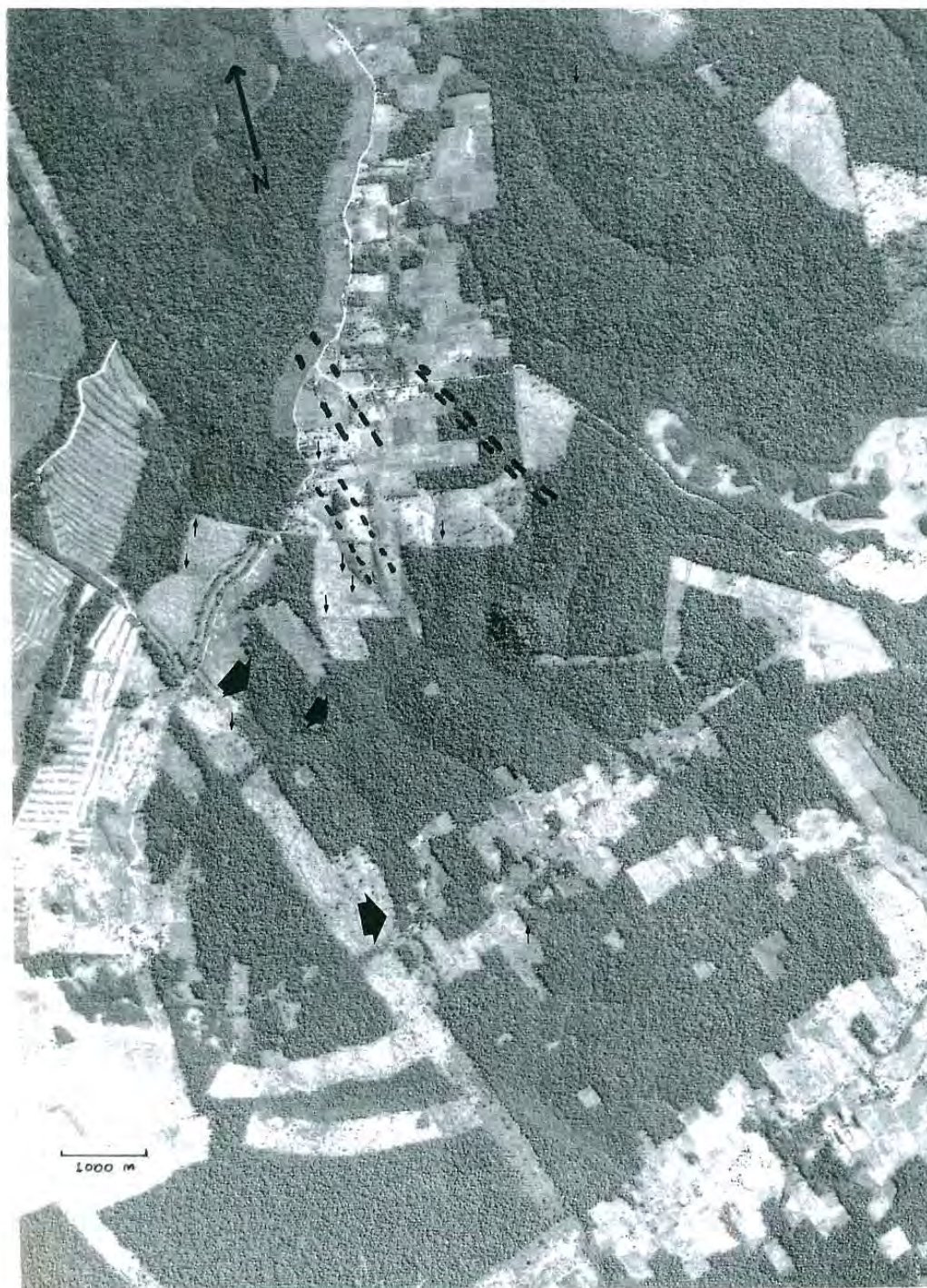
Fotografia 10. Cópia ampliada da fotografia aérea 1:65.000 do I.G.M. (Paraguai) a ~10 Km SW da cidade Paso Yobai, onde são mostrados os diques “lamprofíricos” (setas Yzu-10 (rumo N-S), que ocorrem associados com veios/filões de quartzo aurífero (rumo E-W, em setas pequenas). Em linhas de traços alguns diques de diabásio toleitico (Serra Geral ou Fm. Alto Paraná, no Paraguai); litologias encaixadas em sedimentos do Grupo Independencia (Permiano).
