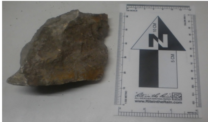
Figura 11: Muestra San Miguel N° 3: mineral del talco levemente silicificado presenta fractura concoide, coloración de color crema, dureza 1 \cong 2,5 y raya blanca.
