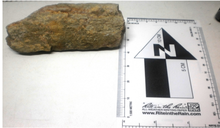
Figura 9: Muestra San Miguel N° 1: Cuarzita (Roca de caja), roca foliada dada por la orientación de los minerales de cuarzo de color rosado y bandas de segregación, también presenta minerales de fengita (variedad de la muscovita) que le da una coloración verdosa.
