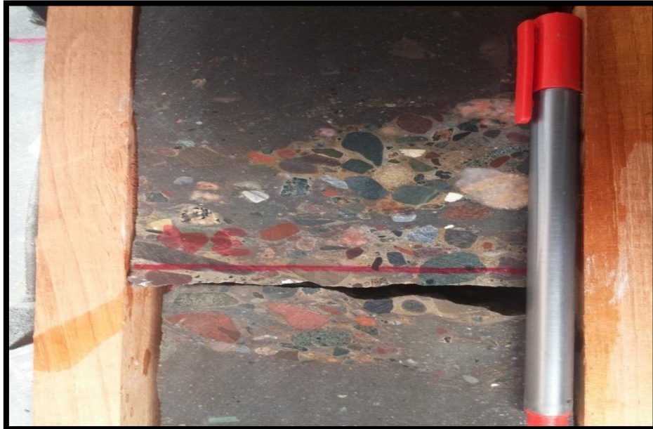
Fotografía 8: Tillitas finas y medias glaciares, correspondiente al segmento número 4, se observan a tillitas con clastos medios metidos en forma de cuña en unas tillitas más finas.
