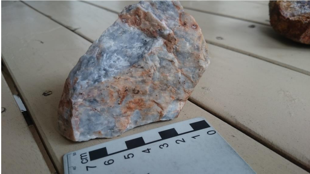
Figura 10. Detalle de la muestra Y-01, cuarcita blanca a gris-blanquecina de textura granoblástica en contacto con cuarcitas ferruginosas.
