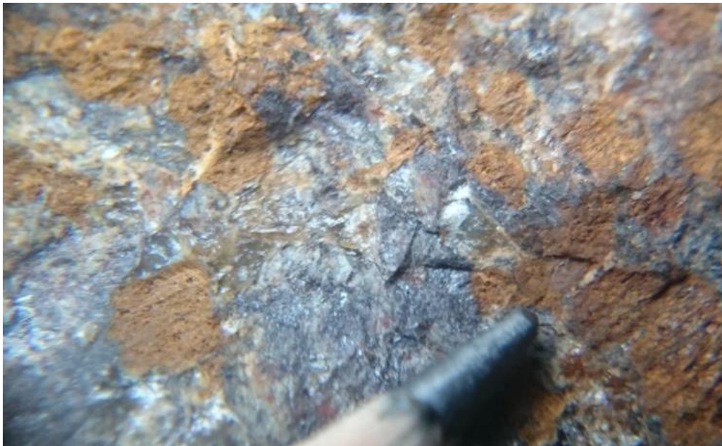
Figura 14. Oquedades subcuadrangulares rellenas de goethita por alteración de magnetita. Muestra Y-05. Aumento 10x.
