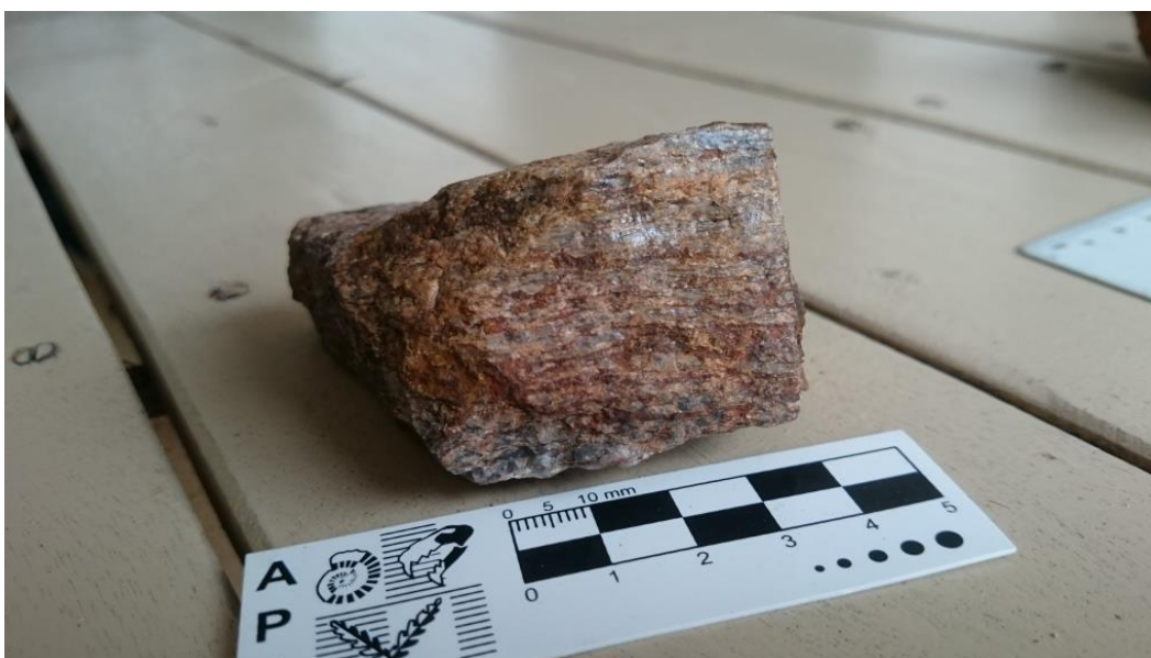
Figura 11. a) y b) Cuarzita ferruginosa donde se observa la estructura bandeada en la roca con alternancia de bandas leucocráticas (cuarzo) y melanocráticas (minerales de hierro) de escala milimétrica. También se evidencia deformación en bandeamiento y sobrecrecimiento de cristales. Muestra Y-03.
