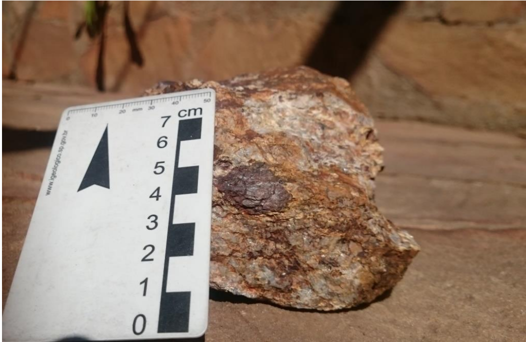
Figura 13. Porfidoblasto de hematita color marrón rojizo en cuarcita ferruginosa. Muestra PP-420.
