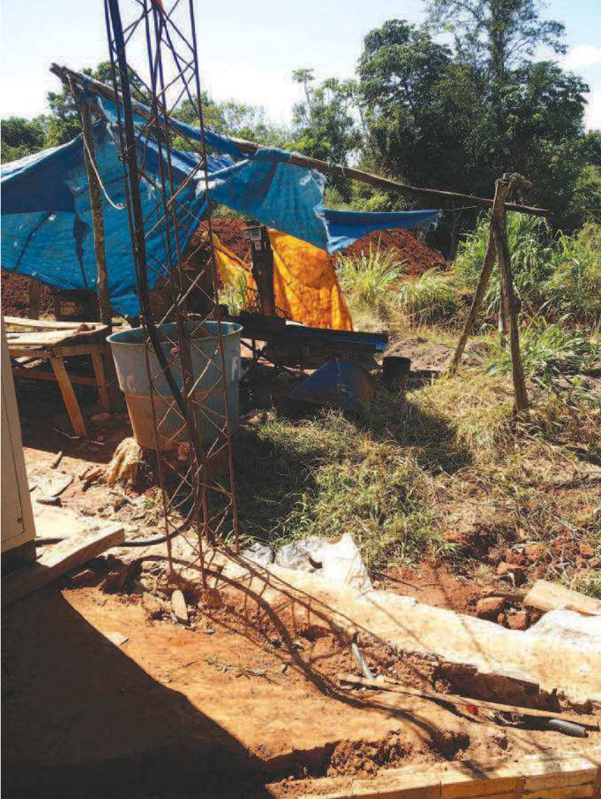
Foto 3. Pequeño molino de procesamiento de oro con mercurio.
