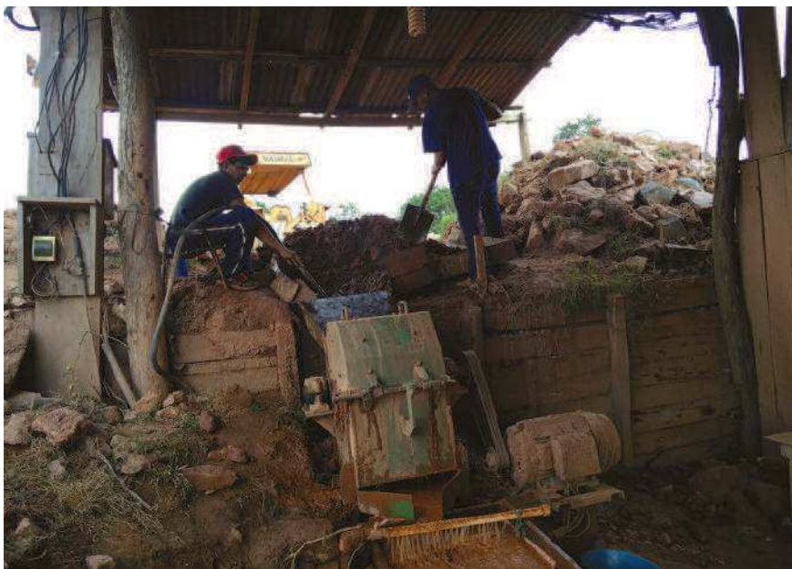
Foto 4. Molino mediano de procesamiento de oro con mercurio.
