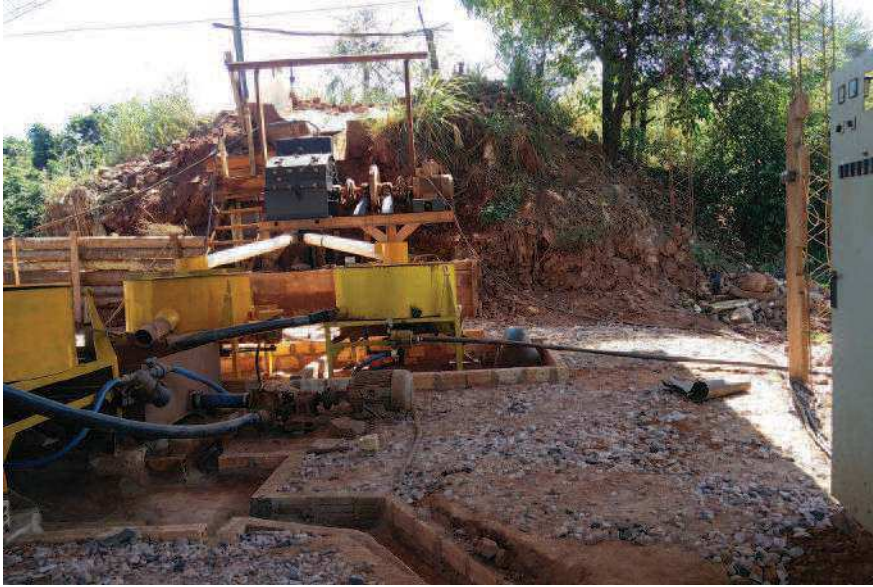
Foto 5. Molino semi-industrial de procesamiento de oro, con técnicas diversas, trituración de piedras y mercurio.
