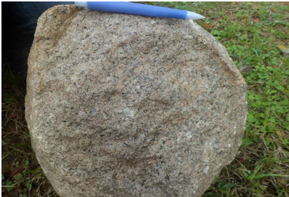
Figura 7. Granito porfírico, ubicado en las inmediaciones de la Compañía Costa Jhú camino al Lago Ypoa. Fotografía tomada por autor.
