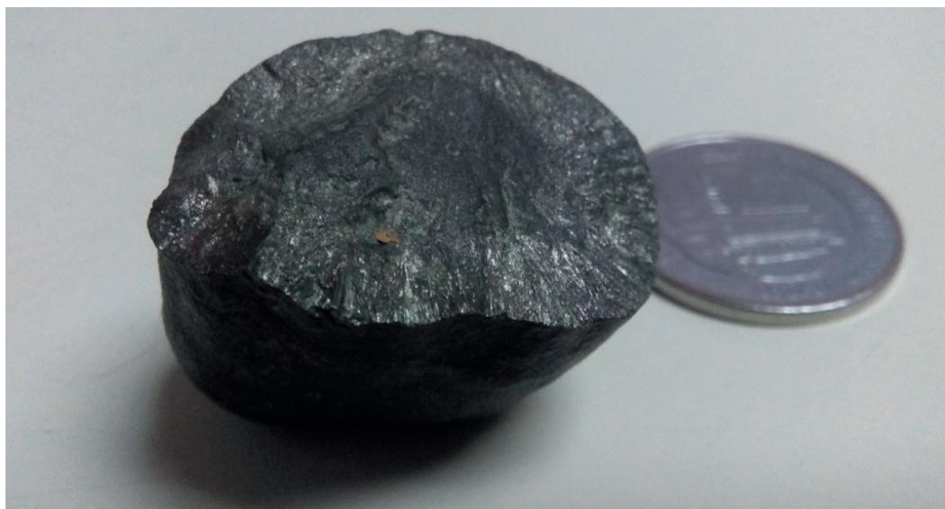
**Figura 3** - Muestra del mineral de sulfuro de hierro obtenido de la antigua mina en Valenzuela. Su hábito fibroso radial a partir de un núcleo es patente en la imagen.
