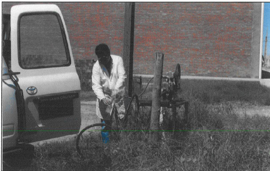
Figura 2.2 Amostragem da água subterrânea do aquífero freático por meio de bomba de diafragma
