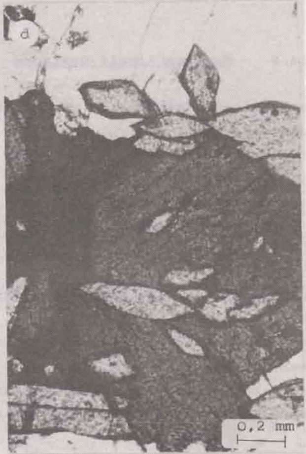
Abb. 4.5a: Gefüge und Mineralparagenese eines Alkali-Syenits. Ein älteres, idiomorphes Sanidinkorn ist von einer zweiten Sanidin-Generation eingeschlossen. Zonar gebauter hypidiomorpher Aegirin, hypidiomorph prismatischer Apatit und spätauskristallisierter Calcit sind ebenfalls zu erkennen. Probe S1, X-Polarisatoren, Vergrößerung 25x.
