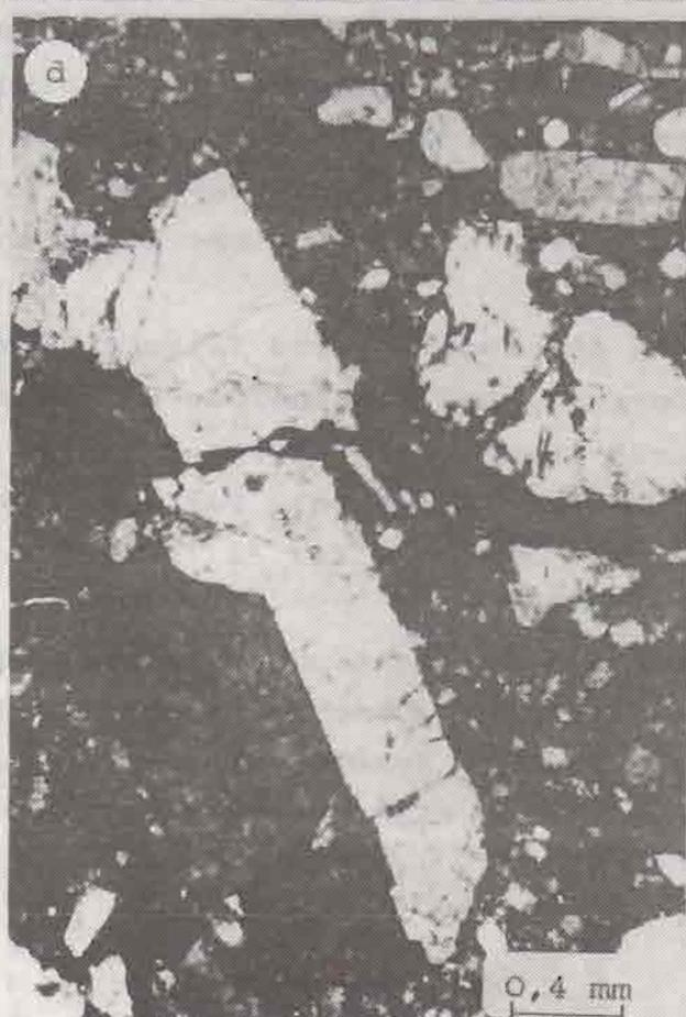
Abb. 4.6a: Die Unterscheidung zwischen Kalifeldspat (frisch) und Nephelin (verwittert) wird in den Nephelin-Syeniten aufgrund der unterschiedlichen Verwitterungsresistenz beider Minerale erleichtert. Zahlreiche Aegirinnadeln sind in den poikilitischen Sanidinkristallen zu erkennen. Probe C-42, // -Polarisatoren, Vergrößerung 50x.
